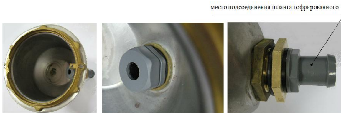
Последовательность сборки сальника
