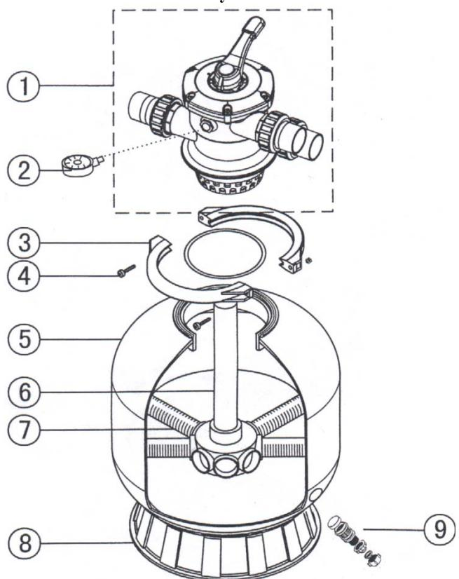
Детализировка «Позиции 2 Таблицы 2» (Вентиль 6-ти поз.(верхний 1½") для фильтра Emaux (Opus) MPV-01C изображена на рисунке 4.
