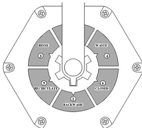
После промывки фильтра необходимо производить **уплотнение** фильтрующего материала (песка) в режиме уплотнения схема движения воды выглядит следующим образом: вода из ванны подается насосом на фильтр, далее проходит прямым потоком через фильтр (сверху вниз) и сбрасывается в канализацию. В режиме уплотнения фильтрующего материала (песка) положение ручки вентиля показано на рисунке 7.
