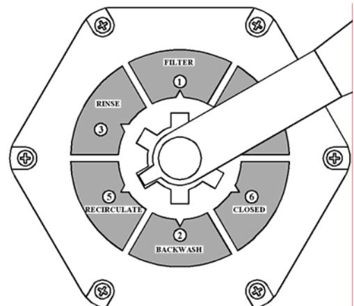
В режиме CLOSED 6-ти поз. вентиль закрыт. Движение жидкости через 6-ти поз. вентиль не осуществляется. В режиме CLOSED положение ручки вентиля показано на рисунке 10.
