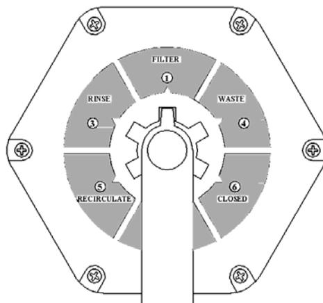
**В режиме промывки** фильтра схема движения воды выглядит следующим образом: вода из ванны подается насосом в фильтр, далее проходит обратным потоком через фильтр (снизу вверх) и сбрасывается в канализацию. При промывке фильтра, для избежания завоздушивания и выхода из строя (поломки) насоса, забор воды рекомендуется осуществлять через донные сливы ванны бассейна. В режиме промывки фильтра положение ручки вентиля показано на рисунке 6.
